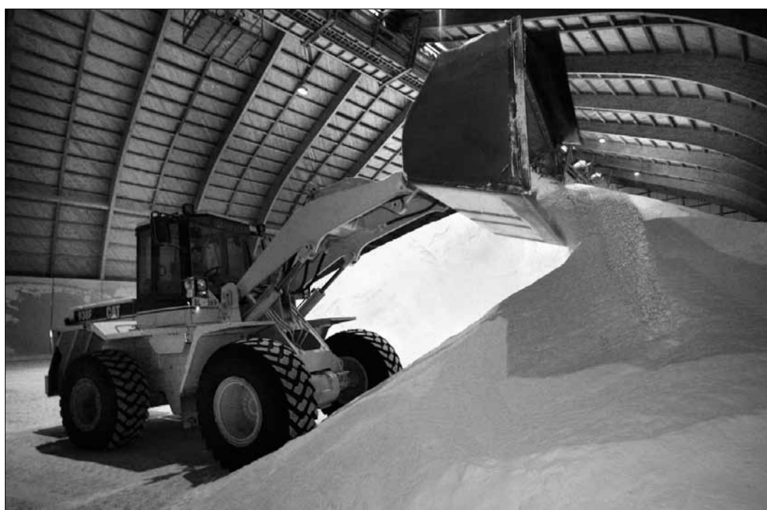
Dépôt de sel à Schweizerhalle. Le hangar peut contenir environ 15000 tonnes de sel. La saline de Schweizerhalle produit environ 200000 tonnes de sel par année en utilisant la technique d'ébullition de la saumure. (photo keystone)
