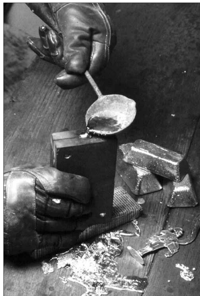
A l'aide d'une cuillère de moulage, l'étain, chauffé à environ 400 degrés, est versé à la main dans le moule en ardoise à double face. L'air peut s'échapper par de fins canaux gravés. (photo Zinnfiguren Wilhelm Schweizer)
