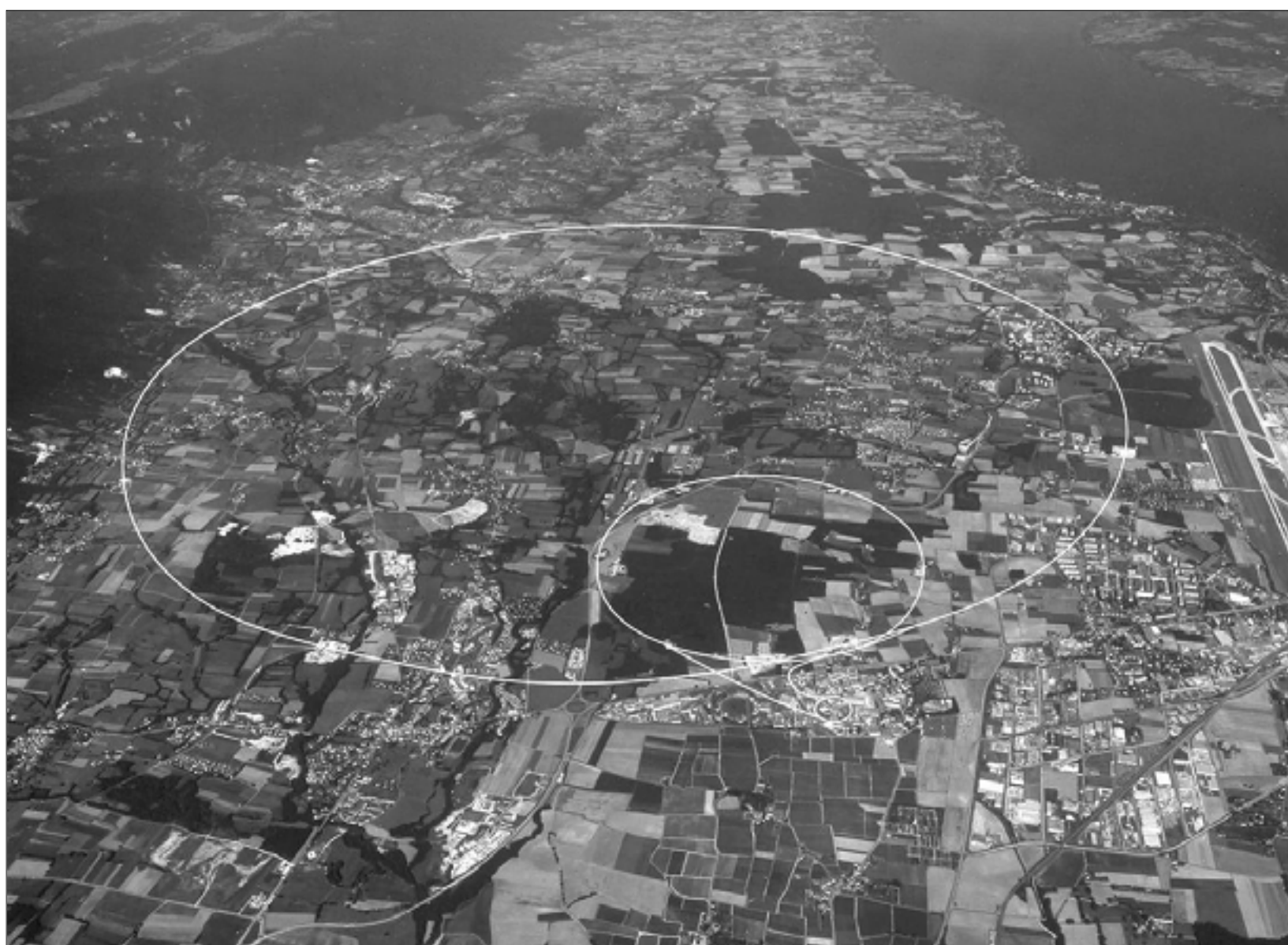
Genève avec à l'arrière-plan le lac Léman. Le petit cercle signale le tunnel du Proton Synchrotron (PS), le cercle moyen celui du Super Proton Synchrotron (SPS), de 7 km de circonférence, et le grand cercle, dont la circonférence est de 27 km, celui de l'accélérateur LHC. (Photo © CERN)
